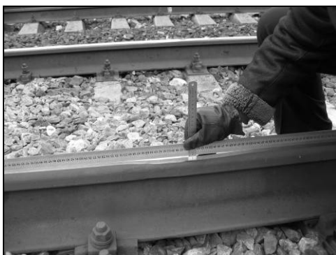
Рис. 13. Измерение параметров смятия головки рельса (длина — 30 см, глубина — около 3 мм)
