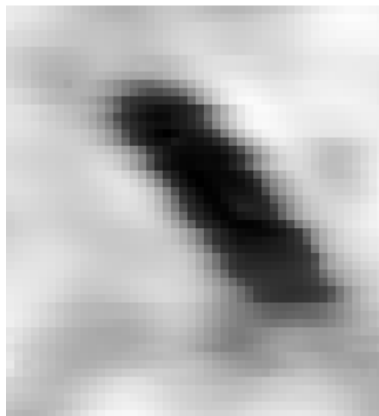
Рис. 11. Радиоизображение макета мины ПТМ-3 в песчаном грунте
