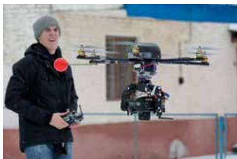
Рис. 1. Общий вид ДПЛА вертолетного типа: а) общий вид ДПЛА в полете с фотокамерой, установленной в карданном подвесе; б) на заднем плане оператор с пультом управления ДПЛА
