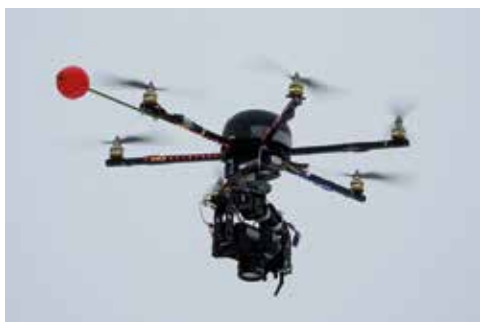
Рис. 1. Общий вид ДПЛА вертолетного типа: а) общий вид ДПЛА в полете с фотокамерой, установленной в карданном подвесе; б) на заднем плане оператор с пультом управления ДПЛА
