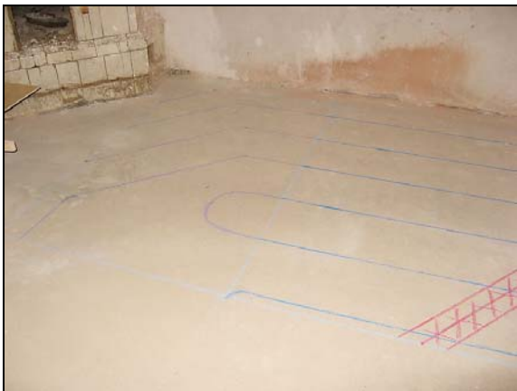
Рис. 6. Расшифровка полученных радиоизображений пола и нанесенное на поверхность пола положение труб и кабелей
