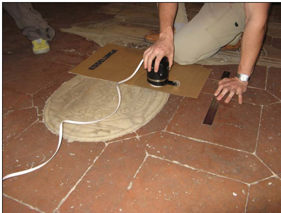
Рис. 11. Проведение работ с помощью радиолокатора Раскан-4/4000
