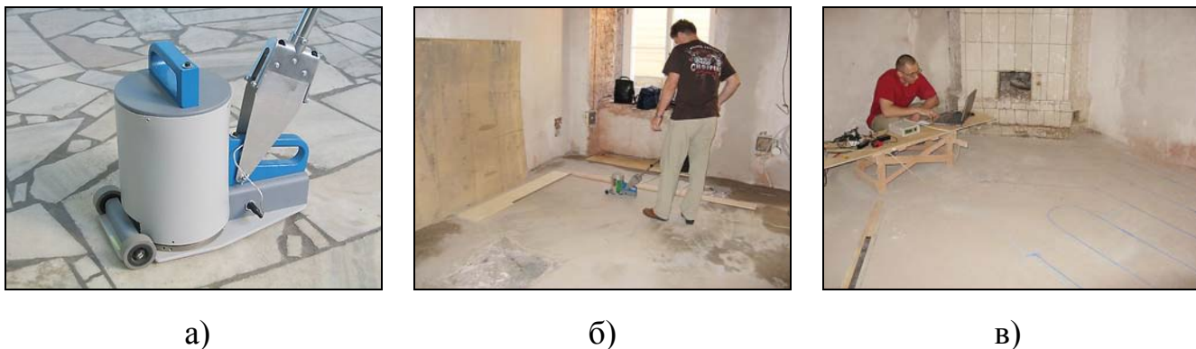
Рис. 2. Радиолокатор РАСКАН-4/2000 во время выполнения работ
